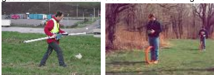
Figuur 2.1. Uitvoering EM31 en EM34 metingen.
