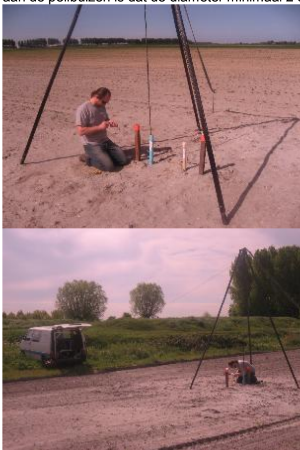
Figuur 4.1. Boorgatmeting met electromagnetische sonde, om een diepteprofiel van het geleidingsvermogen te verkrijgen.
